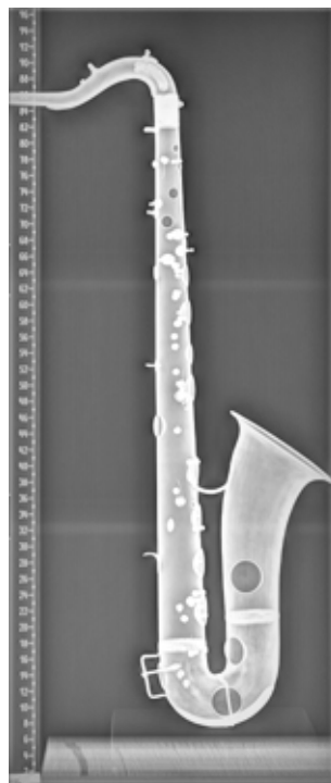
Röntgenový snímok tenorsaxofónu z dielne A. Saxa z r. 1861 bez mechaniky (zdroj: archiv A. van Zoelena)
