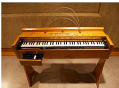
Martenotove vlny, naľavo sa nachádza „kabinet“ s regulátorom hlasitosti a spínače na modifikáciu farby zvuku (foto: archív)
