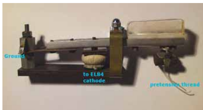
Mechanika regulátora hlasitosti citlivého na tlak – Touche d'intensité (foto: archív)
